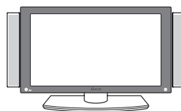
Altoparlanti installati sui lati destro e sinistro
