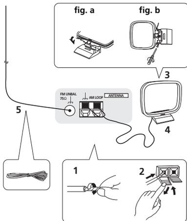
**1** Retirez les gaines protectrices de chacun des fils de l'antenne AM.
