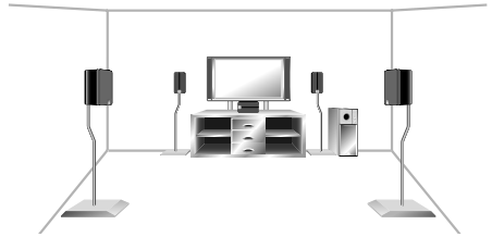
3-D-Ansicht der Lautsprecheraufstellung (VSX-D711)
