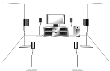
3-D-Ansicht der Lautsprecheraufstellung (VSX-D811S)
