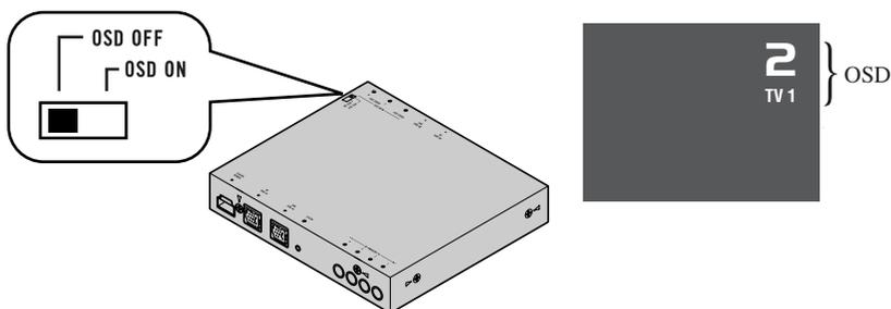
Réglez le commutateur OSD (Affichage sur l'écran), placé sur le côté droit de cet appareil, sur la position convenable compte tenu de l'appareil auquel il est associé; utilisez pour cela la pointe d'un stylo à bille ou un instrument similaire.
