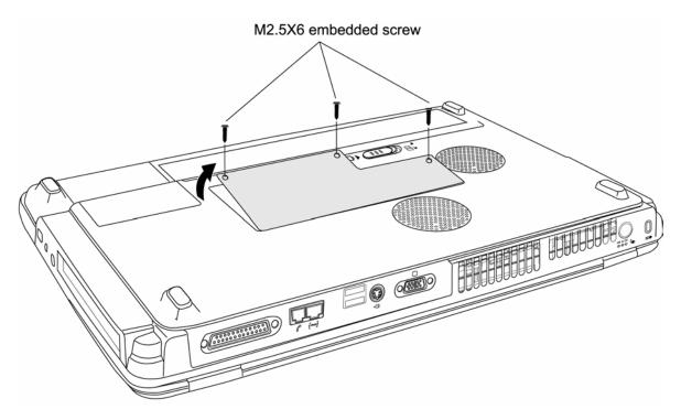
Figure 4-9 Removing the mini PCI bracket
