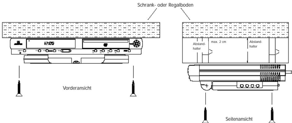
1) Wählen Sie eine geeignete Einbaustelle an der Unterseite eines Schrank- oder Regalbodens aus. Für eine leichte und ordentliche Installation sollten sich Steckdosen, TV-Antennen-, und Kabel-TV-Anschlussbuchsen in unmittelbarer Nähe zum Gerät befinden. Bringen Sie das VE 1020 nicht über einem Herd oder Ofen an. Vergewissern Sie sich vor den folgenden Arbeitsschritten, dass die vorgesehene Einbaustelle genügend Platz für die Anschlüsse auf der Geräterückseite bietet.
