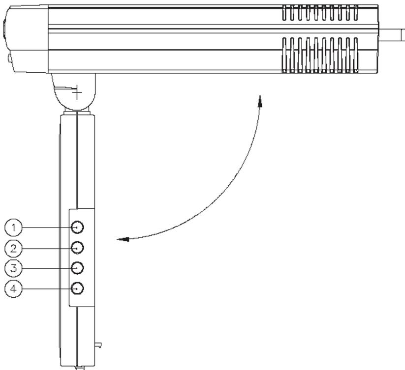
**1) Menü Taste** - Drücken Sie diese Taste, um in das Menü LCD Funktionen zu gelangen.
