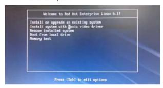
At the boot:, type vnlinuz initrd=initrd.img xdriver=vesa nomodeset dd , then press <Enter>.
