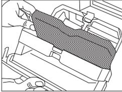
und Fasern bedeckt ist, muss er gereinigt werden. Waschen Sie den Schwamm von Hand aus, drücken Sie überschüssiges Wasser heraus. Nach dem Auswaschen können winzige Faserreste in den Poren zurückbleiben; dies ist in Ordnung.
