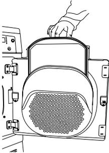
So reinigen Sie den Filter:
