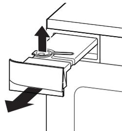
Falls Sie das Leeren des Wassertanks vergessen sollten, stoppt die Maschine bei vollem Tank; die „Tank voll“-Hinweisleuchte leuchtet auf. In diesem Fall leeren Sie den Wassertank und drücken zur Fortsetzung die Start/Pause/Abbrechen-Taste.
