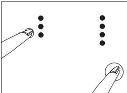
Kindersicherung halten Sie dieselben Tasten erneut 2 Sekunden lang gedrückt. Die Kindersicherung wird abgeschaltet, die Hinweisleuchte erlischt.
