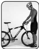
Figura 1. Comprobación de las funciones del manillar y el vástago
