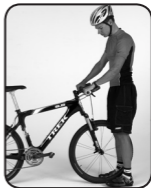
Abbildung 1: Funktionstest von Lenker und Vorbau Deutsch 2
