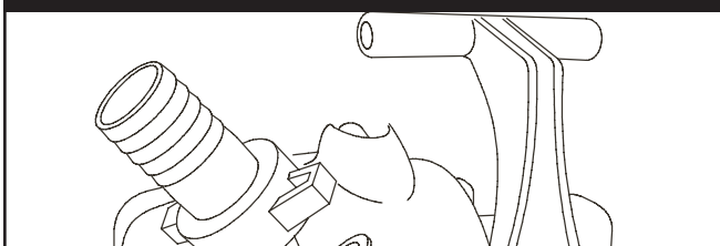
Figura 55 - Conecte el conector de la manguera a la bomba
