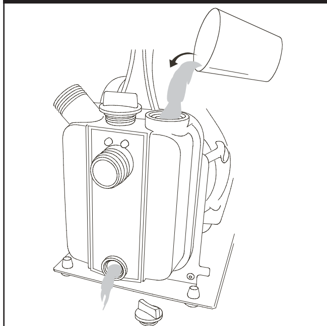
Figure 43 — Retirer le bouchon sur le dessus de la pompe et rincer
