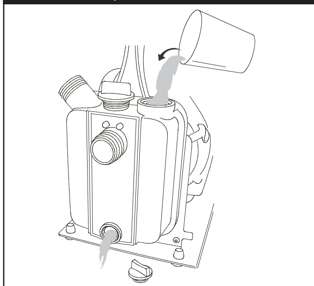
Figura 67 - Quite el tapón de la parte superior de la bomba y lave la bomba
