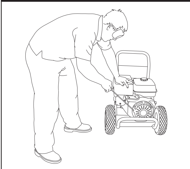
Figura 23 - Posición Recomendada para el Arranque
