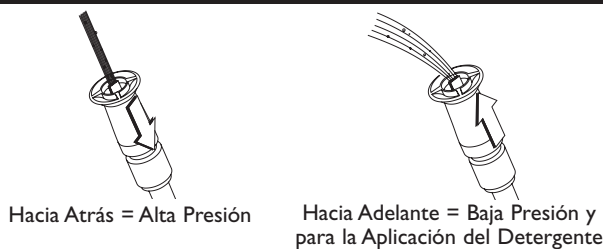
Figura 34 — Ajustar la Presión de Aspersión
