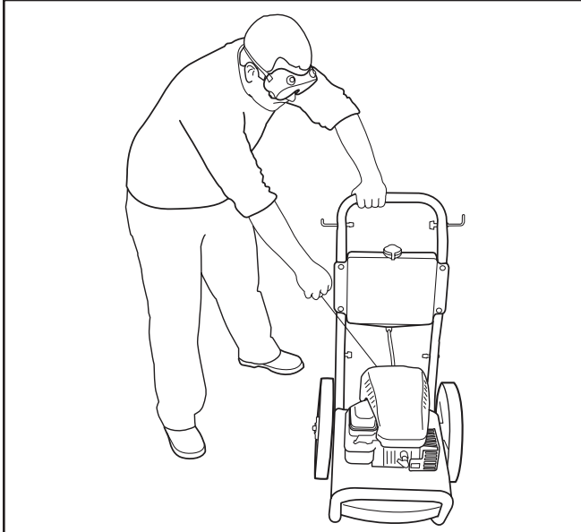
Figura 33 - Posición Recomendada para el Arranque
