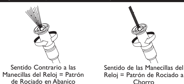
Figura 36 — Ajustar el Patrón de Aspersión
