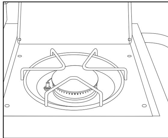
Remarque: Si le brûleur ne s'allume pas ou si sa flamme est trop faible, cela peut être dû à une obstruction causée par des araignées ou d'autres insectes, ou à une activation du limiteur de débit. Voir la rubrique "Assemblage / entretien des brûleurs" de la section "Entretien approprié" ou la rubrique "Réinitialisation du détendeur" de la section "Raccordement de la bouteille de propane liquéfié et de l'ensemble tuyau / détendeur au gril".
