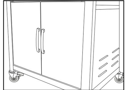
Remarque: Lors de l'exécution de l'étape 9, soulever la cuve pour la séparer des panneaux avant et arrière afin d'éviter de se blesser les doigts.
