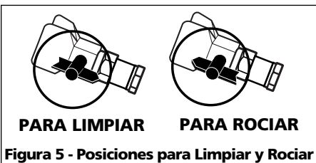
Figura 5 - Posiciones para Limpiar y Rociar
