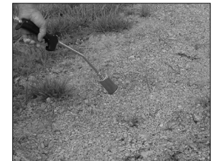
Figura 7 - Accionamiento del gatillo para inyección turbo de la llama (WT4500 se muestra, WT5500 similar)
