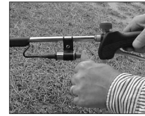
Figura 6b - Uso de un encendedor piezométrico
