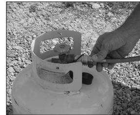
Figura 3 - Ajuste manual de la conexión del cilindro
