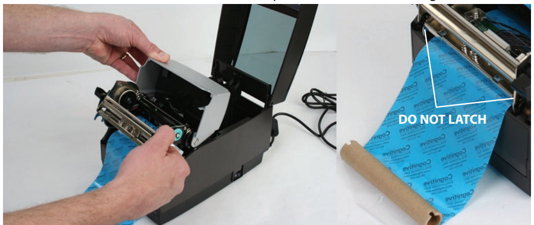
Figura 2-31. Separazione e Abbassamento del Meccanismo della Testina di Stampa dall'Interfaccia Utente Senza Serrare il Meccanismo
