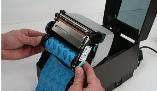
Figura 2-29. Allineamento del Centro del Rullo di Alimentazione con i Dentelli del Fuso del Nastro
