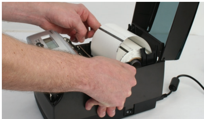
Figura 2-45. Abbassare il Rullo di Prodotto nelle Fessure Inferiori delle Guide di Prodotto
