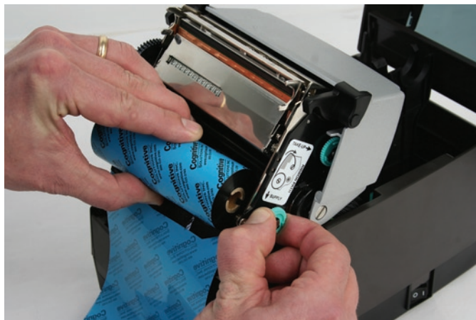
Figura 2-27. Allineamento dei Dentelli Centrali di Alimentazione del Rullo con i Dentelli del Fuso di Alimentazione
