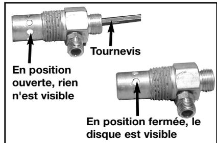
8. Nettoyez ou remplacez la soupape de retenue. Utilisez un solvant, tel qu'un décapant de peinture ou de verni, pour nettoyer la soupape de retenue.
