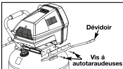
**⚠ MISE EN GARDE** Il s'avérera peut être nécessaire de supporter un côté du compresseur d'air lors du retrait de la palette parce que le compresseur d'air aura tendance à basculer.
