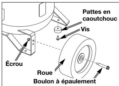
**⚠ MISE EN GARDE** Il s'avérera nécessaire de supporter un côté de l'appareil lors du montage des roues parce que le compresseur d'air aura tendance à basculer.
