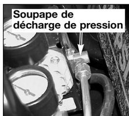
sortir de cette soupape pendant quelques secondes. Vous ne devriez pas entendre une fuite d'air lorsque le moteur est en marche ni une fois que l'appareil a atteint la "pression de rupture".
