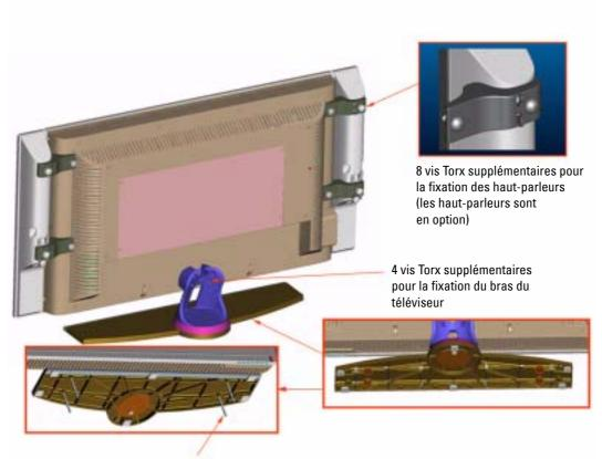
4 vis sans tête filetées T10/M5 pour la partie inférieure du socle du téléviseur
