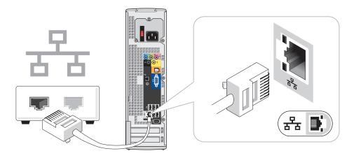
If you want to connect a network device, use a network cable (not included). 如果您需要连接一个网络设备,请使用网络电缆(未附带)。
