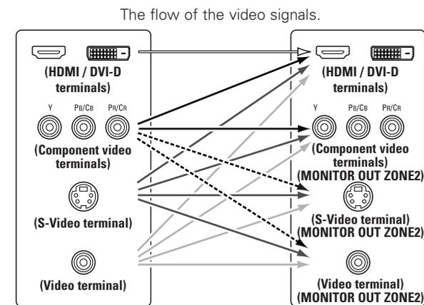
This unit’s input terminals                      This unit’s output terminals
