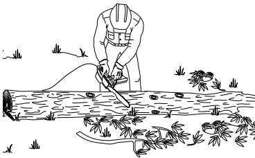
Figure 15 - Bucking Log With Entire Length On Ground Figura 15 - Trozado del tronco completamente apoyado en el suelo Figure 15 - Tronçonnage d'une bille qui repose entièrement au sol
