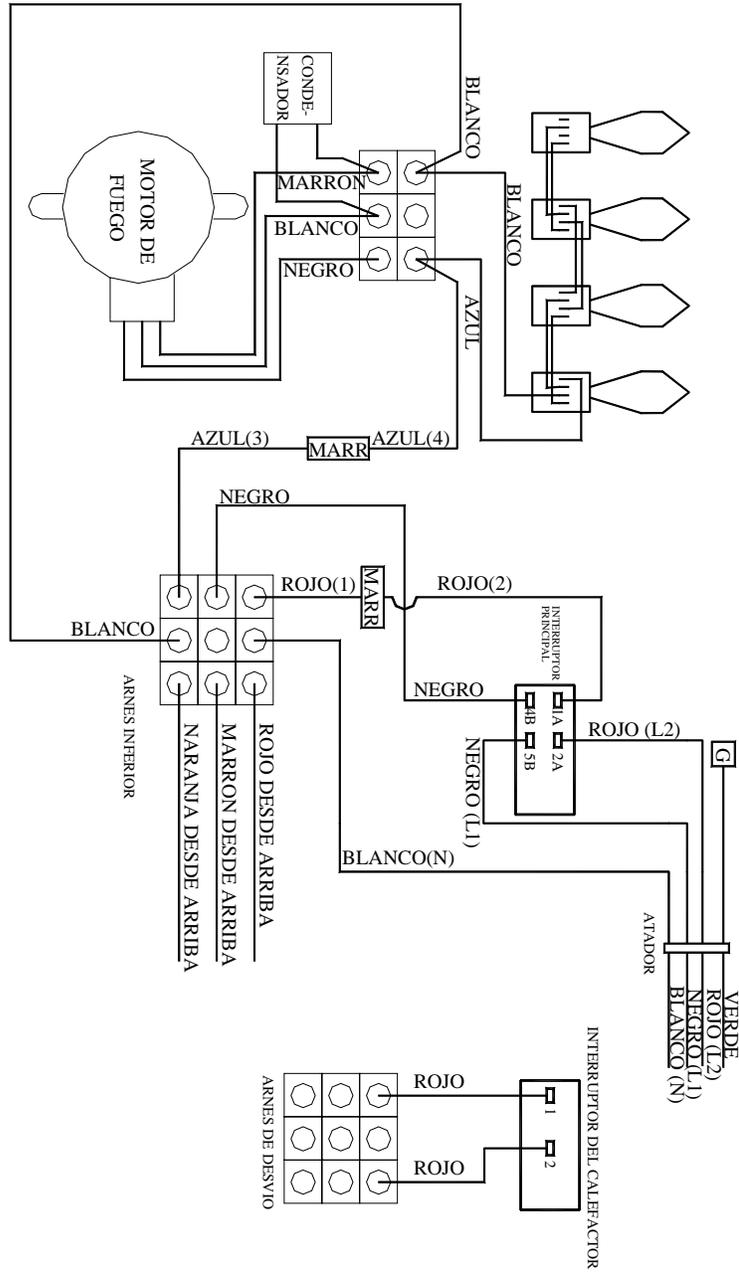
**DIAGRAMA DEL CABLEADO SECCIÓN SUPERIOR**
