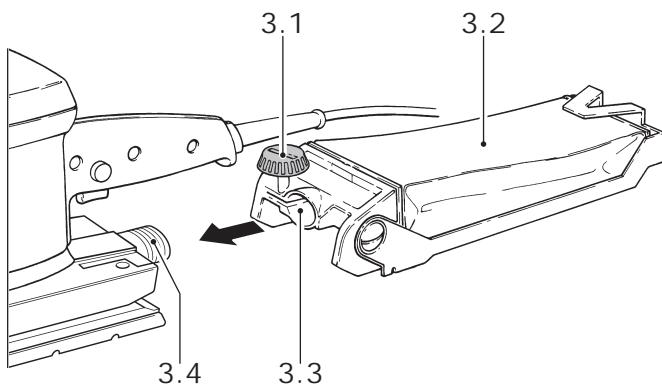
Las máquinas están equipadas como equipo de serie con un dispositivo autoaspirador. Meter el soporte del filtro (3.3) con la abertura hasta el tope sobre la tubuladura de aspiración (3.4) de la máquina y fijarlo con el botón giratorio (3.1).
