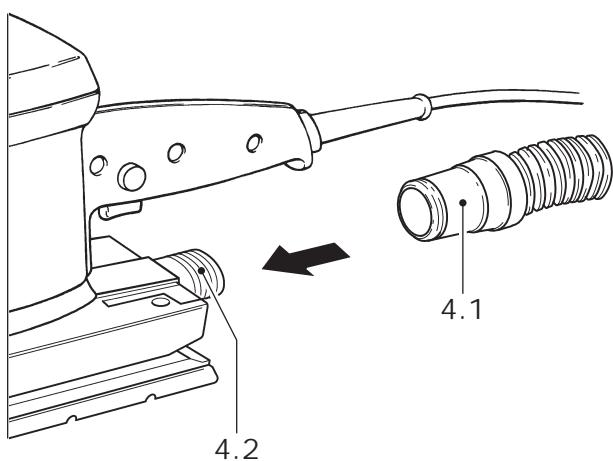
A fin de evitar un frecuente cambio del turbofiltro durante trabajos de lijado relativamente largos, en lugar del dispositivo autoaspirador se puede conectar un aspirador Festool. Para ello se coloca el tubo flexible ( $\varnothing$  27 mm (4.1)) de un aparato de aspiración Festool sobre la tubuladura de empalme del aparato de aspiración (4.2).
