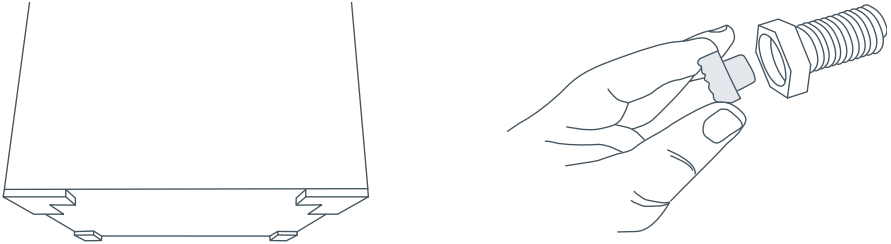
Dibujo 17 Colocación de los insertos de caucho
