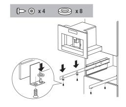
把咖啡机置于滑轨上,把销子正确插入 外壳, 用提供的螺丝把它固定好。 如果需要调整咖啡机高度,要使用提供 的垫板。
