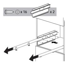
如图所示把滑轨置于柜子侧面。用螺丝 固定滑轨, 然后拉出滑轨。如果把咖啡 机安装在温度较高的抽屉上面, 用抽屉 顶面作为参考面确定滑轨位置。
