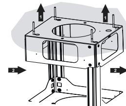
Innan du slutligen drar åt skruvarna är det möjligt att utföra regleringar genom att vrinda stativet men se till att skruvarna inte går ut ur regleröglans säte.
