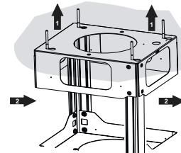
Før du strammer skruene helt er det mulig å utføre justeringer ved å flytte på beslaget. Pass på at skruene ikke glir ut av festeåpningen.
