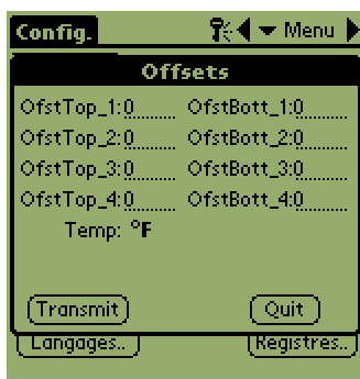
Étape 4: Le menu Cabinet Configuration Offset s'affiche. Les champs d'entrée de décalage pour les logements se présentent de gauche à droite et de bas en haut. Les champs divers en bas de l'affichage sont actuellement inutilisés.
