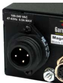
Fig 3.4c AC power input
