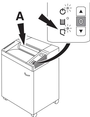
**E** Parada automática si se abre la solapa de seguridad (símbolo parpadea). Cierre la solapa de seguridad para destruir papel. Para retirar los restos de papel de un atasco, la máquina durante un momento en modo invertido con la solapa de seguridad levantada. Si es necesario presione el botón varias veces.
