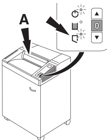
**D** Autom. Stopp wenn Sicherheitsklappe (**A**) geöffnet wird (Symbol blinkt). Sicherheitsklappe schließen Papier wird vernichtet. Zum Entfernen von Papierresten bei einem Papierstau, läuft die Maschine bei geöffneter Sicherheitsklappe nur kurz rückwärts. Bei Bedarf mehrmals Taste drücken.
