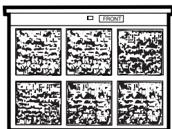
Filtro sucio – necesita limpieza
