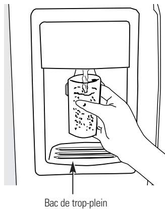
Bac de trop-plein
