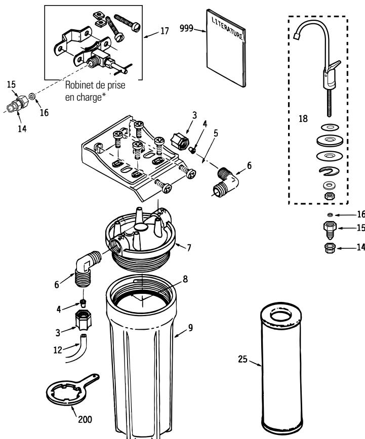
**\*NOTE : Dans l'État du Massachusetts, les codes en vigueur exigent que cet équipement soit installé par un plombier licencié, et que le raccordement à la canalisation d'alimentation ne soit pas effectué par un robinet de prise en charge. Avant l'installation, consulter le code de plomberie 248-CMR du Commonwealth of Massachusetts.**
