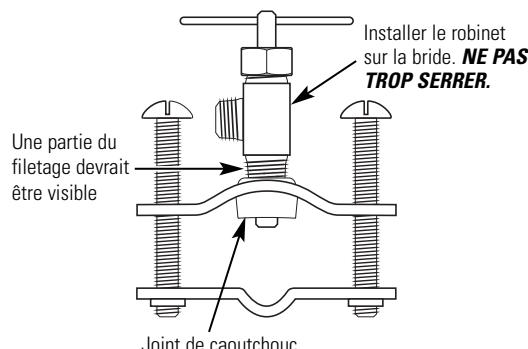
Autre configuration de raccordement (avec robinet de prise en charge)\*
