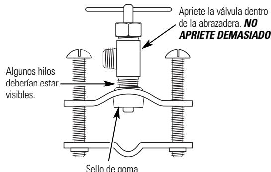
Conexión opcional a línea de agua (usando una válvula "saddle")\*
