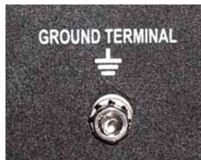
Figure 7 - Mise à la terre de la génératrice
