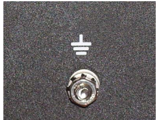
Figura 7 - Conexión a tierra del generador
