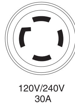
Schéma 7 - Prise de 120/240 Volts CA, 30 Amp
