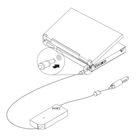
**ステップ 2** 大きい方の電源用コネクターをシガレット・ライター・ソケットに差し込みま す。アダプター・ケーブルのプラグがアクティブな電源に差し込まれると、アダ プター・ボックス上の緑色の発光ダイオードがオンになります。ThinkPad に電 源を供給するには、自動車エンジンを始動する必要があります。
