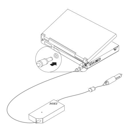
**步驟二** 如下圖所示,拉開電源接頭,然後取下點煙器式整流器。四腳接頭就會露出來。
