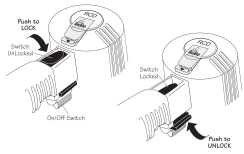
SWITCH FOR RCD Super-8 MODEL NOT SHOWN
