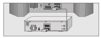
1 Buchse »AV1«, »AV2« oder »AV3« des Fernsehgerätes und die entsprechende Buchse des Video-Recorders, DVD-Players oder der SET-TOP-Box mit einem Euro-AV (Scart)-Kabel verbinden.
