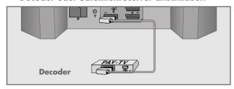
1 Buchse »AV1« des Fernsehgerätes und die entsprechende Buchse des Decoders mit einem EURO/AV-Kabel verbinden.
