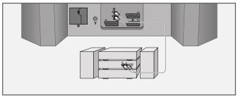
1 Weiße und rote Buchsen »L R AUDIO OUT« des Fernsehgerätes und die entsprechenden Buchsen der HiFi-Anlage mit Cinch-Kabel verbinden.
