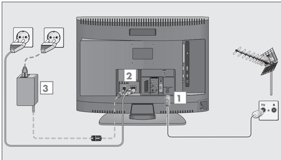
**1a** Zum Empfang terrestrischer Digitalsender (DVB-T) das Kabel der Haus- oder Zimmerantenne (passive oder aktive Zimmerantenne mit eigener Stromversorgung) an die Antennenbuchse »ANT IN« des Fernsehgerätes anschließen;
