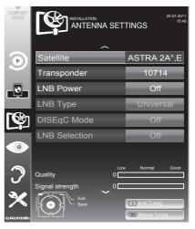
3 Select the line »Satellite« with »v« or »∧« and press »OK« to confirm.
