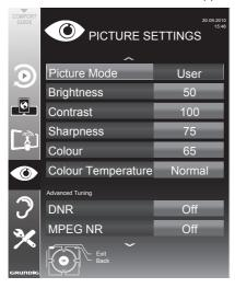
3 Select the line »Picture Mode«, »Brightness«, »Contrast«, »Sharpness«, »Colour«, or »Colour Temperature« with »∨« or »∧«. Select the value with »∢« or »>« and press »OK« to confirm.
