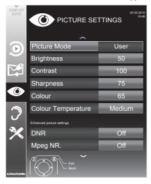
3 Select the line »Picture Mode«, »Brightness«, »Contrast«, »Sharpness«, »Colour«, or »Colour Temperature« with »∨« or »∧«. Select the value with »∢« or »>« and press »●« to confirm.
