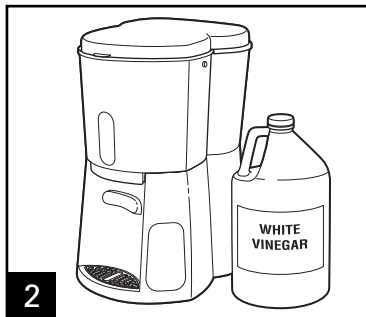
2 Pour 1 pint (2 cups/500 ml) vinegar into water reservoir.
