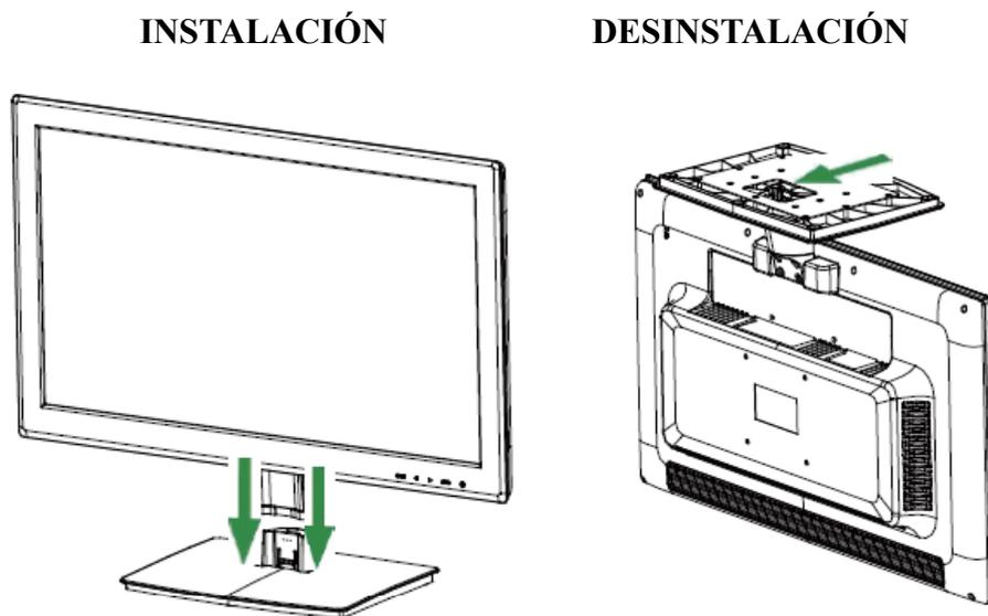
Figura 1. Instalar y desinstalar la base
