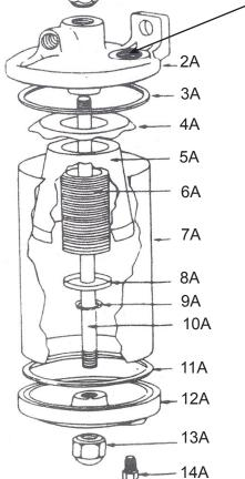
**Description** Part # 1A Plug 2A Filter Cap 3A Gasket 4A Plug 5A Air Valve 6A Filter 7A Housing 8A Filter Washer 9A Retaining Ring 10A Stud 11A Gasket 12A Filter Base 13A Cap Nut 14A Drain Plug
