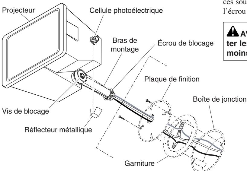
2. Raccordez les fils du luminaire aux fils de la boîte de jonction (**Noir avec noir, blanc avec blanc; fil de mise à la terre du luminaire avec fil de mise à la terre de la boîte de raccordement**). Fixez les connexions avec les serre-fils inclus.
