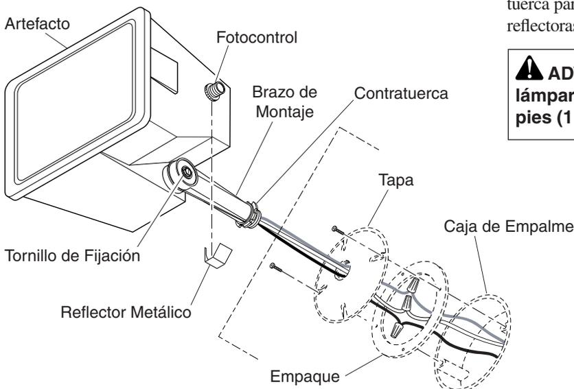
2. Conecte los conductores del artefacto con los de la caja de empalme (**negro con negro, blanco con blanco, y el conductor de puesta a tierra del artefacto con el conductor de puesta a tierra de la caja de empalme**). Asegúrelos con los conectores de cable provistos.
