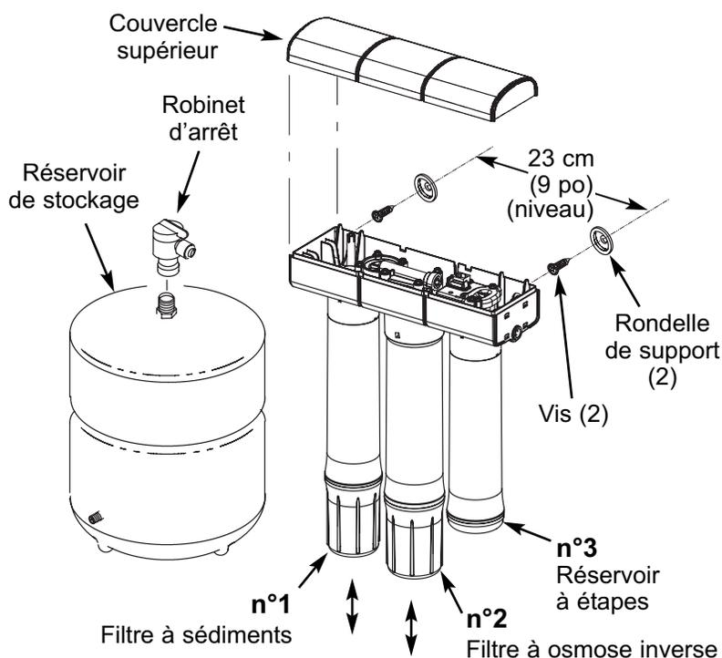
**REMARQUE :** Prévoyez un espace minimum de 4 cm (1 ½ po) sous le système pour déposer et remplacer les filtres.
