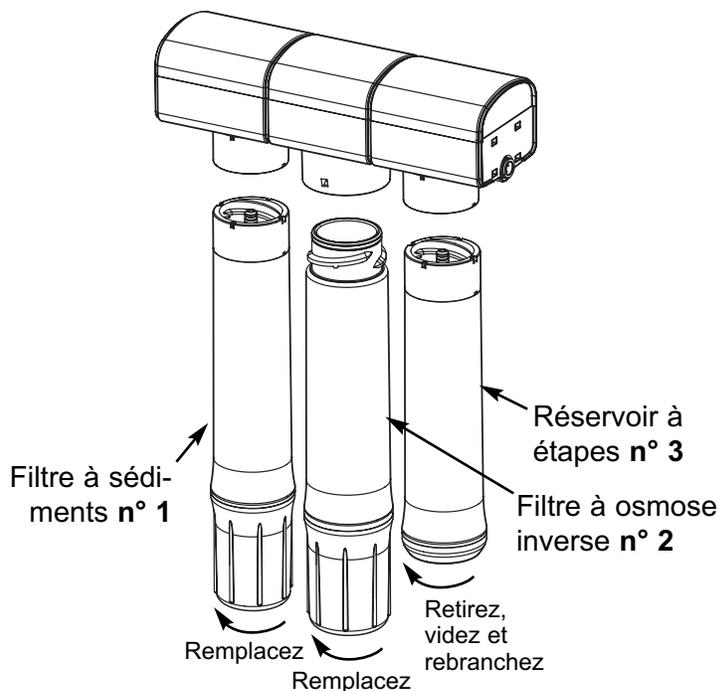
Faites tourner les cartouches dans la direction indiquée par les flèches pour les retirer. Faites-les tourner dans la direction inverse pour les installer.
