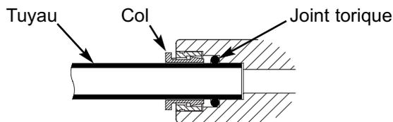
Tube totalement inséré dans le raccord FIG. 14
